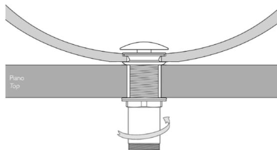
Die Maßtoleranzen (+/-3 mm) und Ebenheitstoleranzen (DIN 18202) unterliegen den üblichen materialspezifischen Toleranzen von Bau- und Werkstoffen, anlehnend an die DIN 18202. Lochbohrungen müssen nach Auflegen des Waschtisches auf die Trägerplatte angezeichnet werden.
